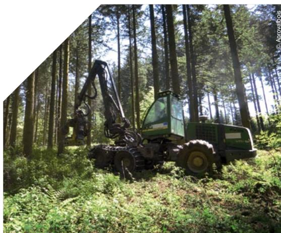
L'abatteuse accomplit les opérations d'abattage, d'ébranchage et de billonnage tout en empilant les produits obtenus.
